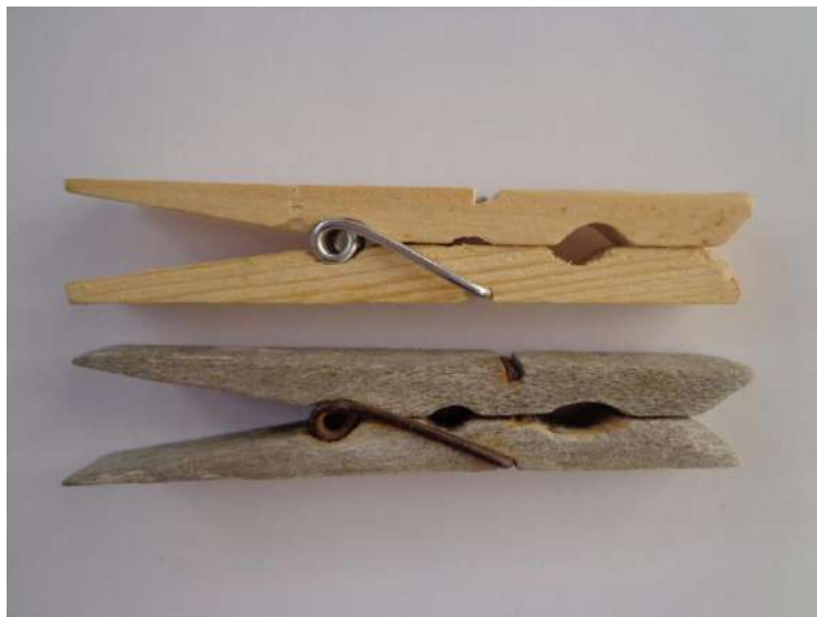
Fig. 46 Los efectos de la luz natural permanente, más las oscilaciones de la temperatura exterior sobre la celulosa se pueden advertir comparando estos dos prendedores o “perros”. El metal tampoco queda exento de sus efectos.
